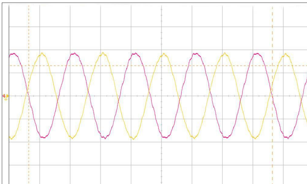
Рисунок 2.1. Осциллограмма входного напряжения и тока (30-ти пульсная схема).
